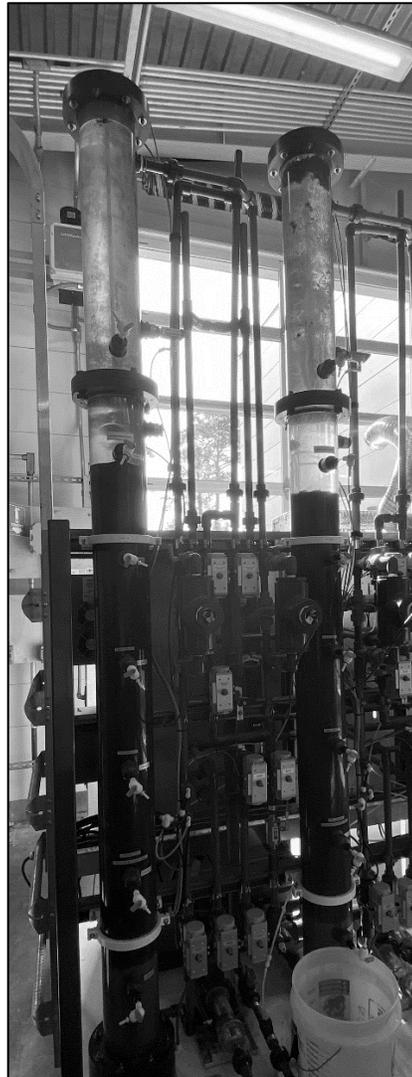
**Figure 15: Intuitech Biofiltration Pilots**
